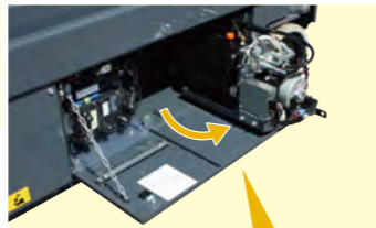
油圧ユニット(右側面)
