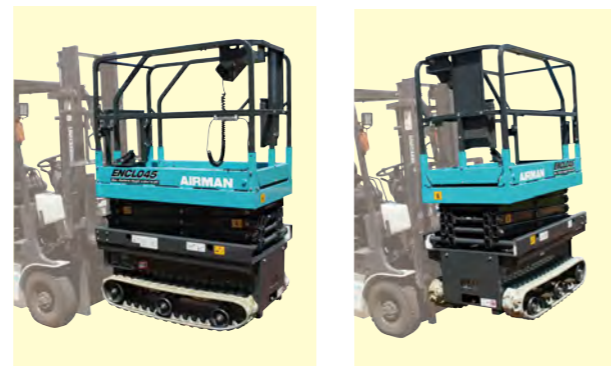
新たに追加された縦方向のフォークポケット (運搬イメージ)
